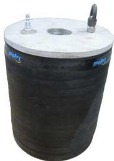
L'obturateur Logiplug court E est construit sur un court mandrin d'aluminium. Il est principalement utile dans les situations où un ballon plus long ne peut être inséré au complet dans la conduite.
