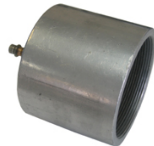
Embout femelle avec gonflage pour tester l'installation du ballon latéral sur son adaptateur.
