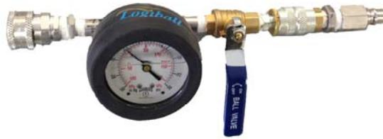
Ensemble pour ajuster la pression d'ouverture des vannes anti-retour sur le packer. Permet aussi de vérifier les fuites sur le packer du côté des boyaux (vacuum et pression).
