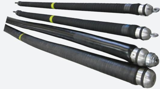
Les mandrins pneumatiques permettent d'installer des gaines de réparation, de longueur de 30cm à 7,5m, dans les conduites de 75mm à 150mm
