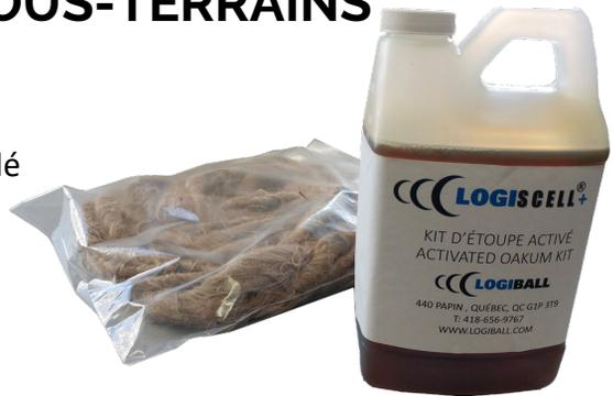
Le kit d'étope activée Logiscell+ consiste en un sac d'étope de jute sèche combiné à une bouteille de résine de polyuréthane hydrophile. Lorsque humectée et calfatée dans un joint ou une fissure, la résine gonfle pour former un joint étanche et flexible. Elle réagit avec l'eau et donne un composé caoutchouteux imperméable et non-toxique. Le cordon d'étope de jute rend le composé dense et résistant, tout en facilitant le calfatage.
